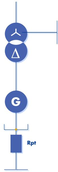
**Figura 10: Esquema unifilar simplificado**
